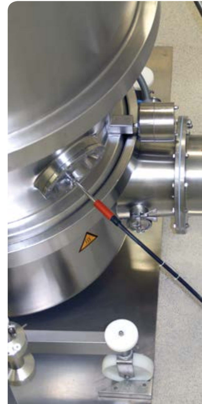
过程探头安装于流化床反应器
